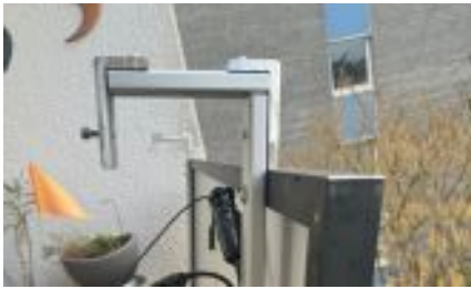
Abb 11 — Für Balkongeländer, die zu breit für Standardhaken sind, eignen sich Haken aus Aluminiumwinkeln und passend zugeschnittenen Profilschienen •
